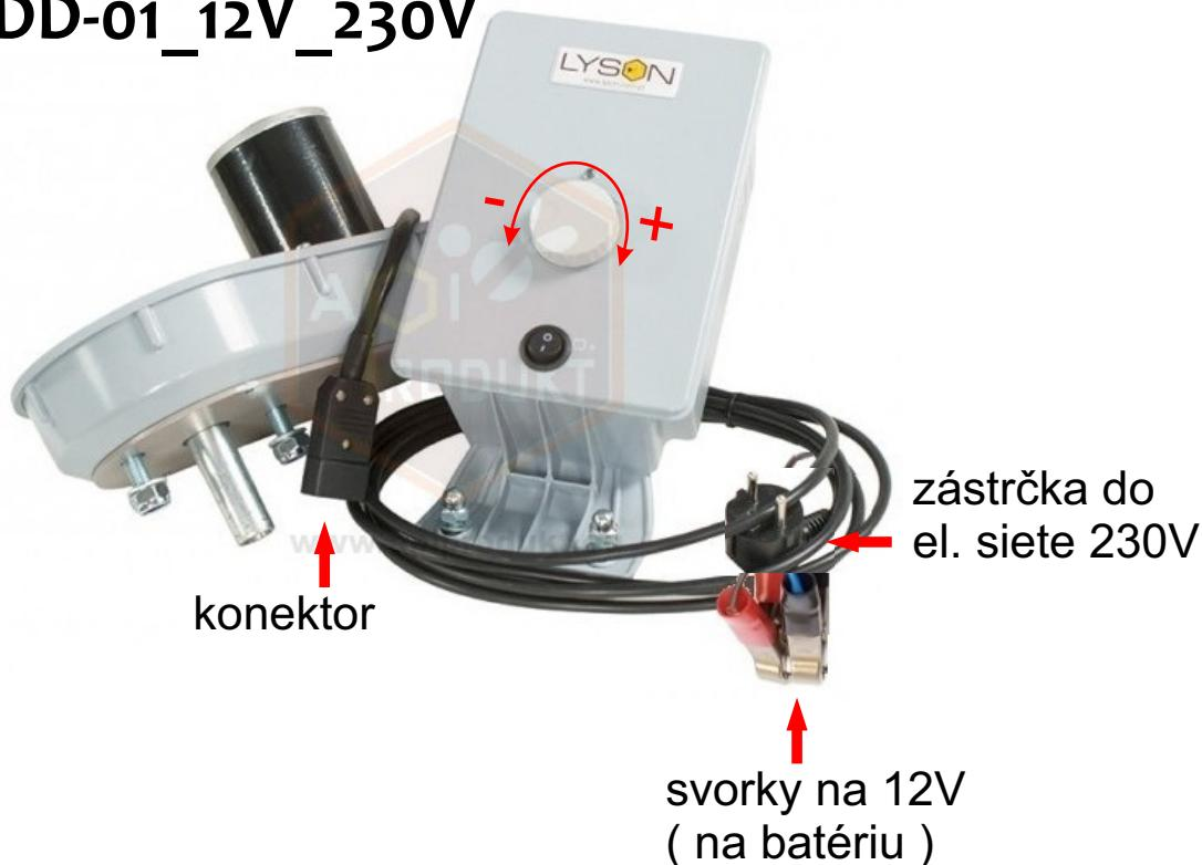
Motor nasadíme na osku medometu, priskrutkujeme na lištu, takisto prisrutkujeme na lištu ovládanie. Konektor zapojíme do zásuvky ovládania. Zapojíme do el. siete. Na ovládaní prepneme vypínač do polohy 1. Otáčky medometu pridávame z polohy - do polohy +. V prípade použitia na 12V akumulátor nezapojíme sietový kábel do el. zásuvky, ale pripojíme svorky na akumulátor. + na + a - na -.
