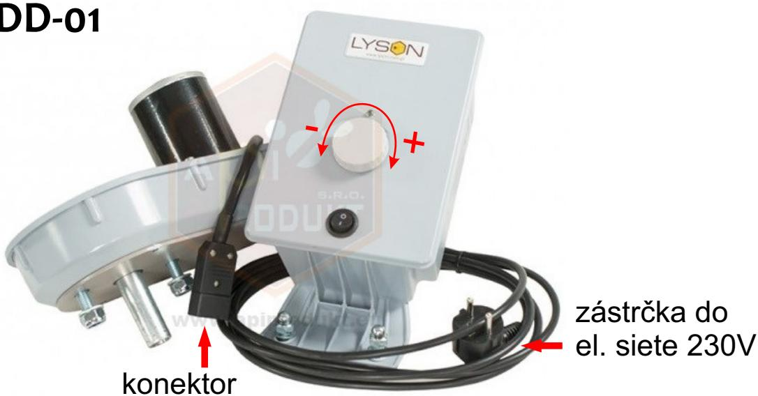
Motor nasadíme na osku medometu, priskrutkujeme na lištu, takisto prisrutkujeme na lištu ovládanie. Konektor zapojíme do zásuvky ovládania. Zapojíme do el. siete. Na ovládaní prepneme vypínač do polohy 1. Otáčky medometu pridávame z polohy - do polohy +.
