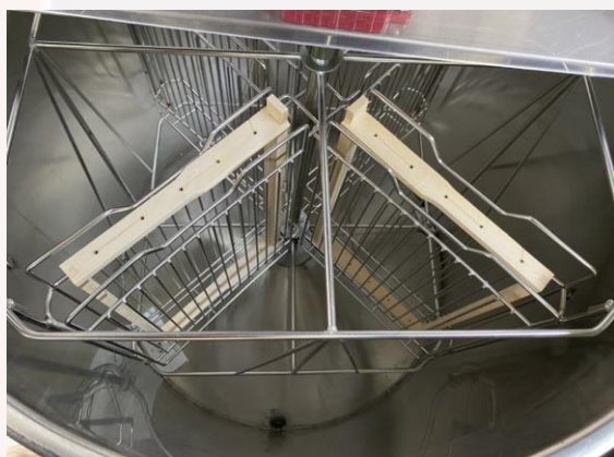
Obr. 1: správne uloženie rámkov v radiálnom medomete
